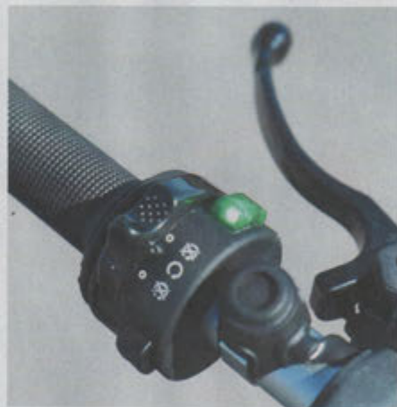
▲ Outre les commutateurs, on retrouve ici un levier, non pas d'embrayage, mais de gestion d'électricité, permettant de couper net l'arrivée d'énergie.
